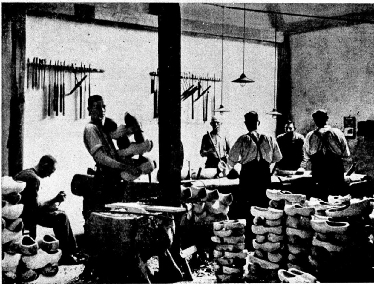
denen Spezialmessern, andere mit Bandsäge, Copier- und Bohrmaschine. Während im handwerklichen Betrieb im Tag sieben Paar Holzschuhe durch eine Person fertiggestellt werden können, vermag im maschinellen Betrieb ein Mann im Tage 14 Paar fertige Holzschuhe aufzuweisen.
